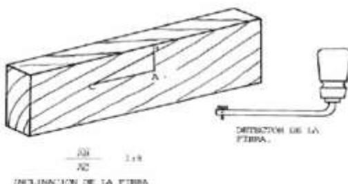
Figura 5. Medición de la inclinación de la fibra.
